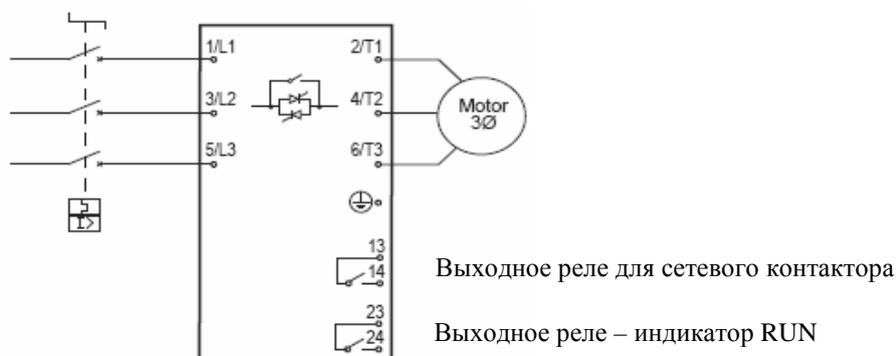
Пример 2: Подключение УПП с автоматическим выключателем и линейным контактором.
