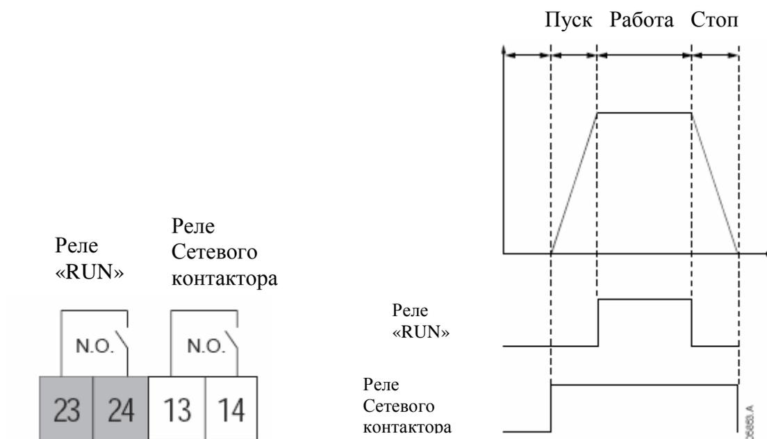
Нагрузка реле: 6 А, 30VDC – резистивная нагрузка, или 2 А, 400 VAC – нагрузка AC11
